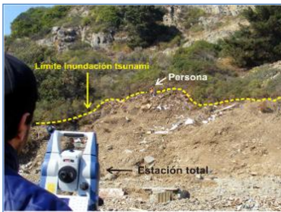
Figura 51. Midiendo con estación total alturas máximas de tsunami en las costas de la ciudad de Constitución, Región del Maule.
