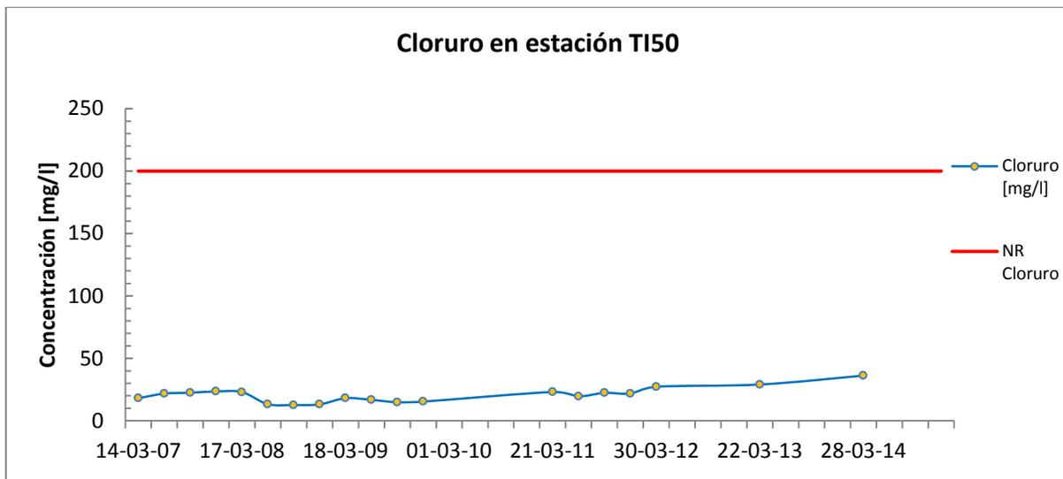
Tal Como se muestra en el gráfico en el total de los muestreos realizados las concentraciones de Cloruro se mantuvieron muy por debajo de las concentraciones permitidas para riego de cultivos agrícolas sin restricción lo que denota una muy buena calidad de aguas sin riesgo de latencia ni saturación del sistema.
