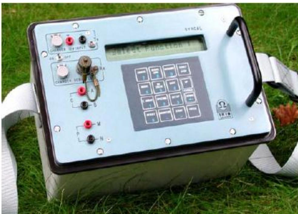
Figura 32. Equipo geoelectrico Syscal R1 Plus SW72 (Iris Instruments).
