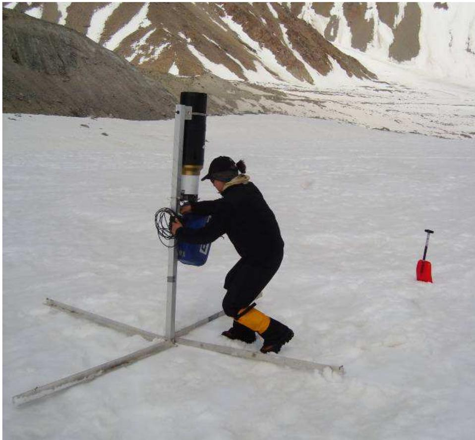
**Figura 3.32.** Mantenimiento del pluviómetro. Altura medida 1,98 m.
