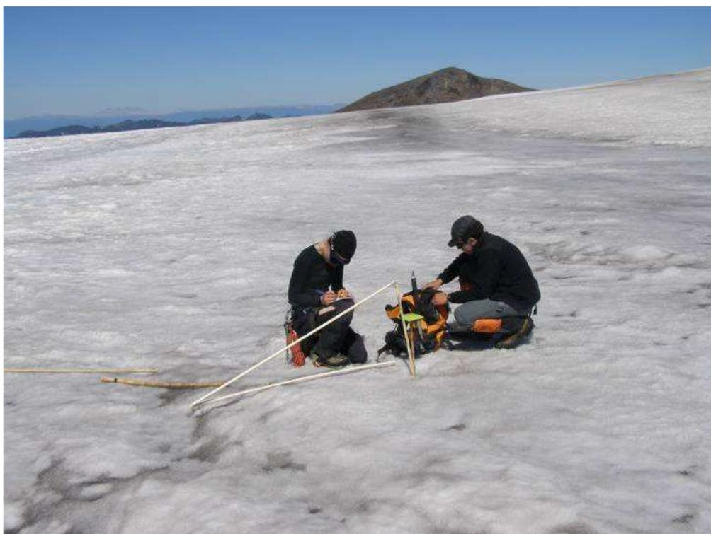
**Figura 3.57.** Control de Balizas de ablación (PVC) en el Glaciar Mocho.
