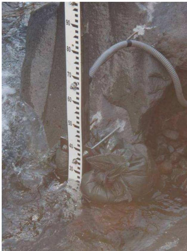
**Figura 3.63.** Regla limnimétrica y transductor.
