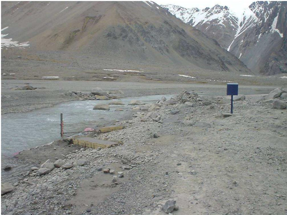
**Figura 3.35.** Estación fluviométrica instalada cerca del frente del glaciar. Vista aguas abajo.
