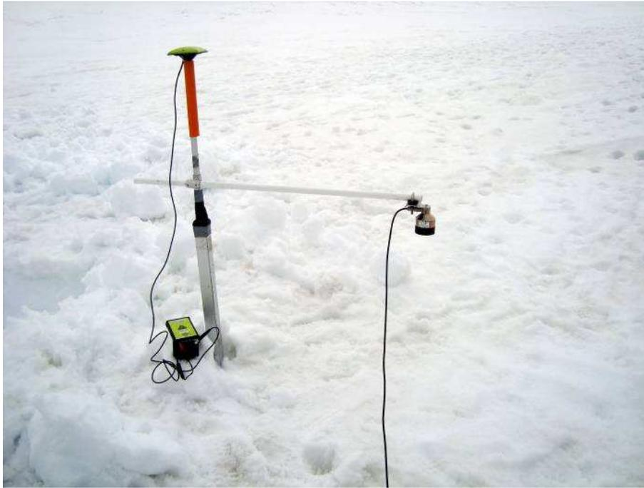
**Figura 3.31.** Estado en que se dejó funcionando el sensor de altura en perfil independiente de 4 m de altura. El sensor queda a una altura medida de 79,7 cm.
