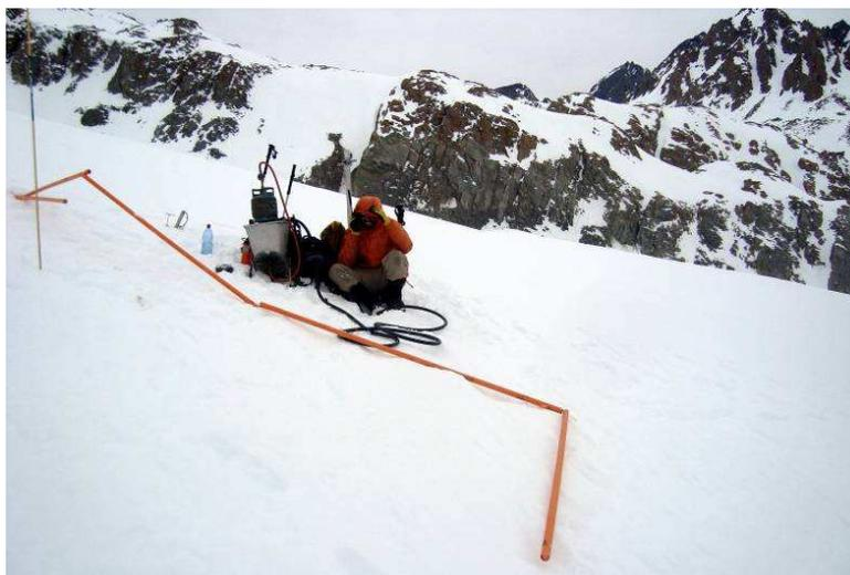
**Figura 3.27.** Perforación con taladro Heucke para instalación de Baliza Nº 7 a 2940 m s.n.m.
