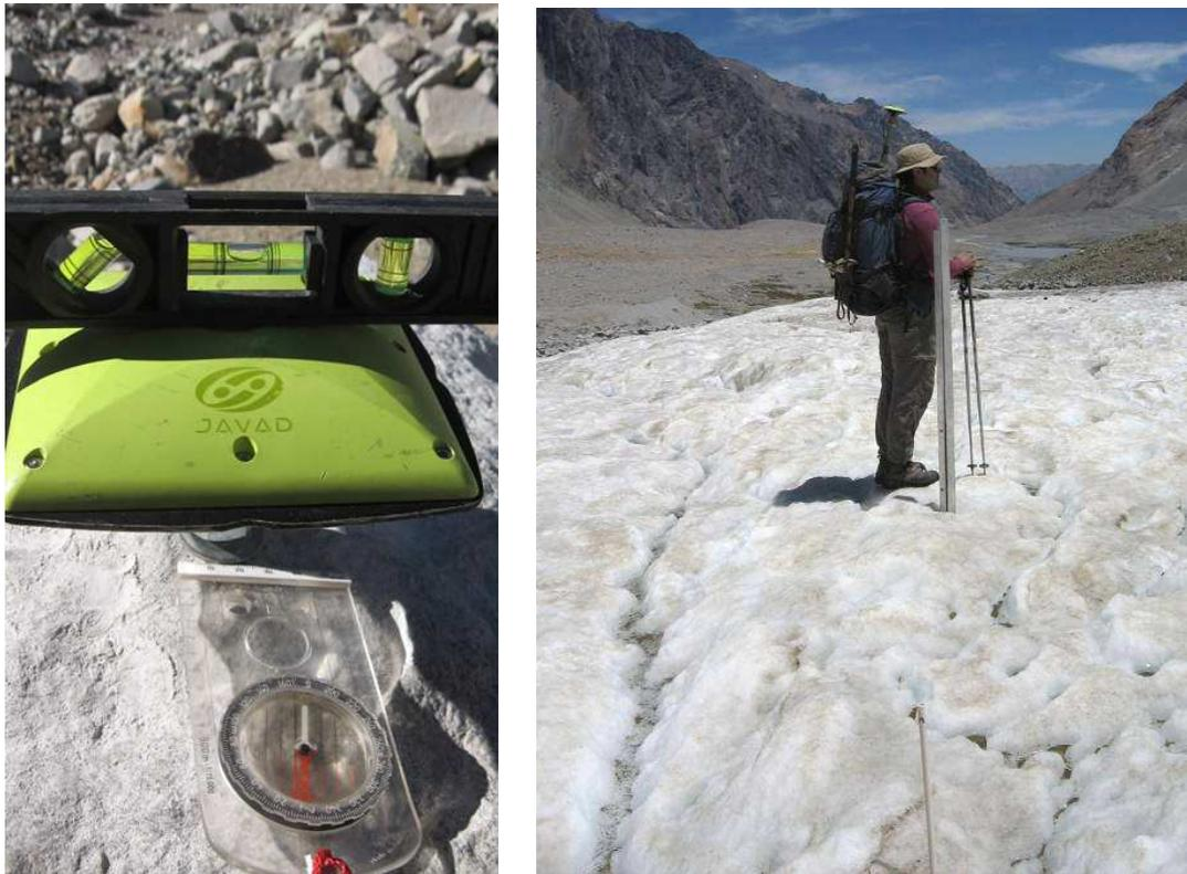
**Figura 3.12.** Izquierda: Monumentación para GPS base. Derecha: Perfil de aluminio para estación meteorológica montada sobre la zona de ablación del glaciar Universidad. Fotos: M. Rodríguez.
