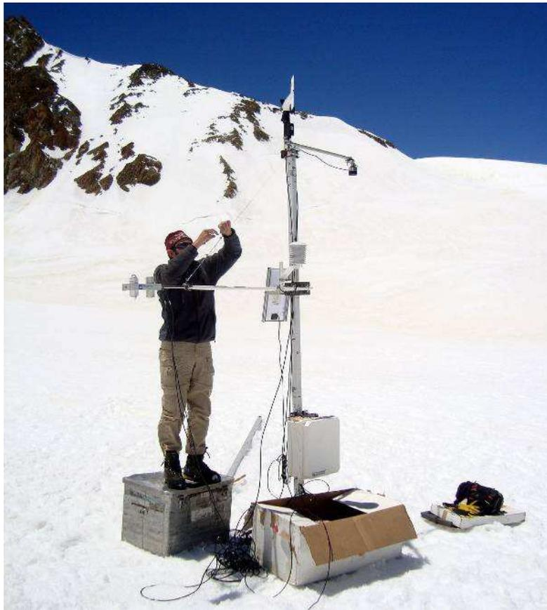
**Figura 3.38.** Instalación de estación meteorológica.
