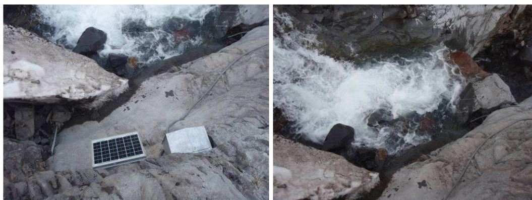
**Figura 3.59.** Estación fluviométrica y sección de aforo. Vista hacia abajo. En la figura izquierda se observa el panel solar y la caseta. A la derecha la sección del estero. Las fotos son previas a la instalación del sensor de nivel, cuyo cable se puede observar en el borde derecho de ambas fotos.
