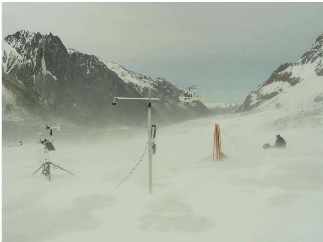
**Figura 3.34.** Estación meteorológica, sensor de altura y pluviómetro.
