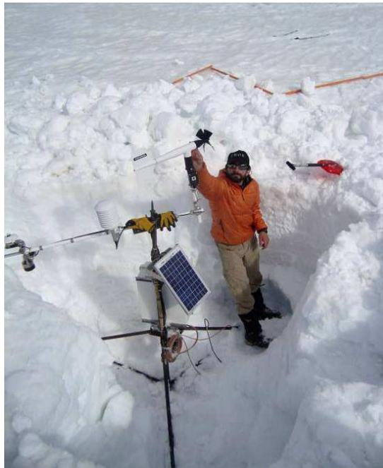
**Figura 3.25.** Excavación de la estación meteorológica (1,5 m de nieve).
