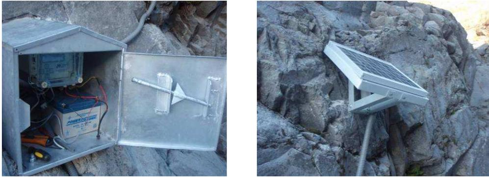
**Figura 3.62.** Caseta, datalogger, batería y panel solar.
