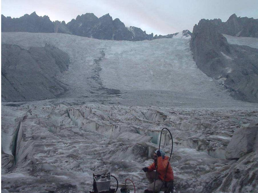
**Figura 3.20.** Camilo Rada reinstalando la baliza N° 4 y efectuando mediciones con GPS.
