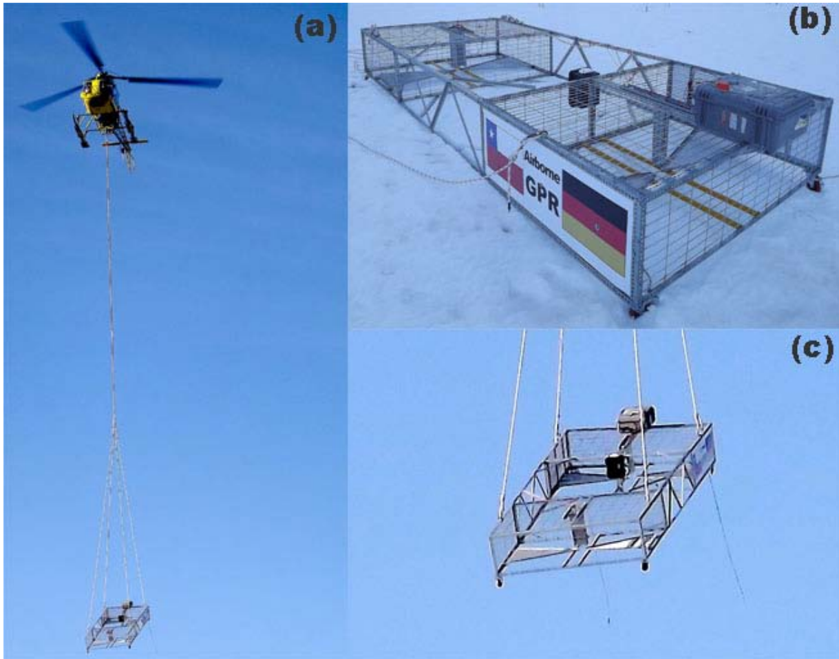
Figura 3.2.1 Sistema RES de 50 [MHz]. Antena sostenida por helicóptero (a) y un acercamiento(c). La misma antena sobre el suelo (b). Imágenes tomadas en Julio 2012. Fuente: Elaboración propia.
