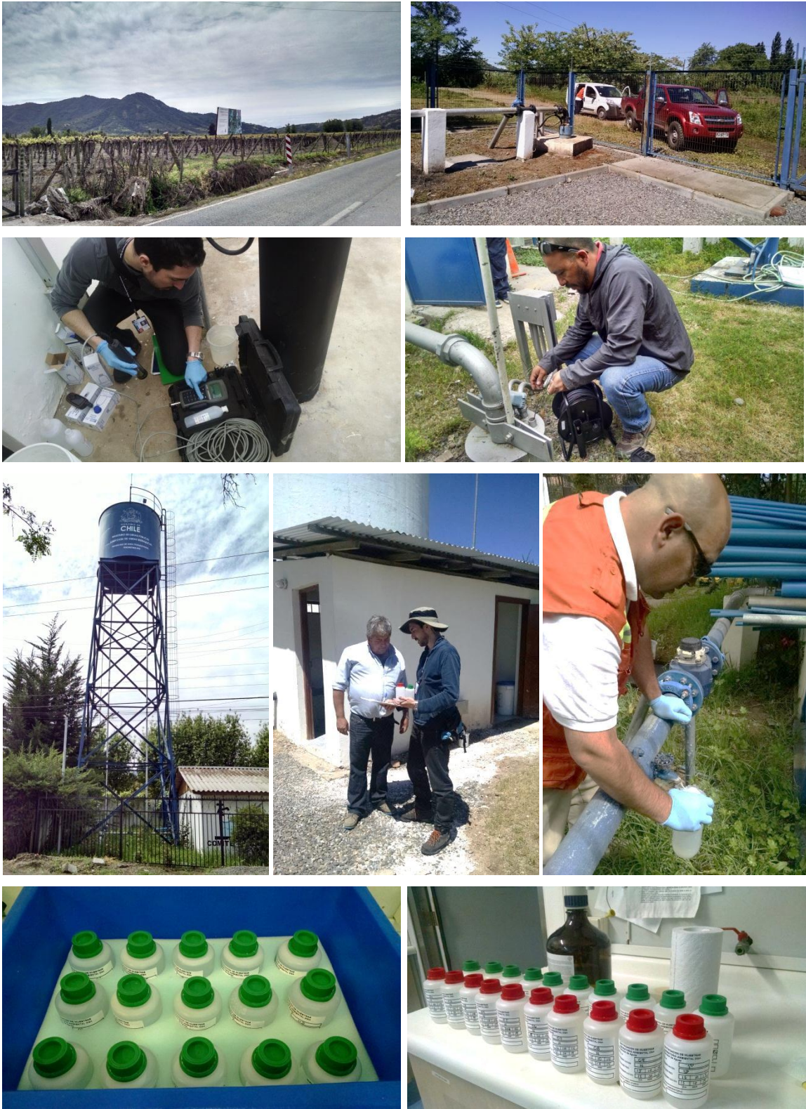
Figura 10: Actividades desarrolladas en terreno durante el muestreo de aguas subterráneas llevado a cabo durante octubre de 2014 en pozos de la VI Región.
