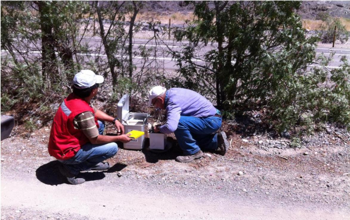
Foto 1. Mediciones gravimétricas en el valle del río Pulido.
