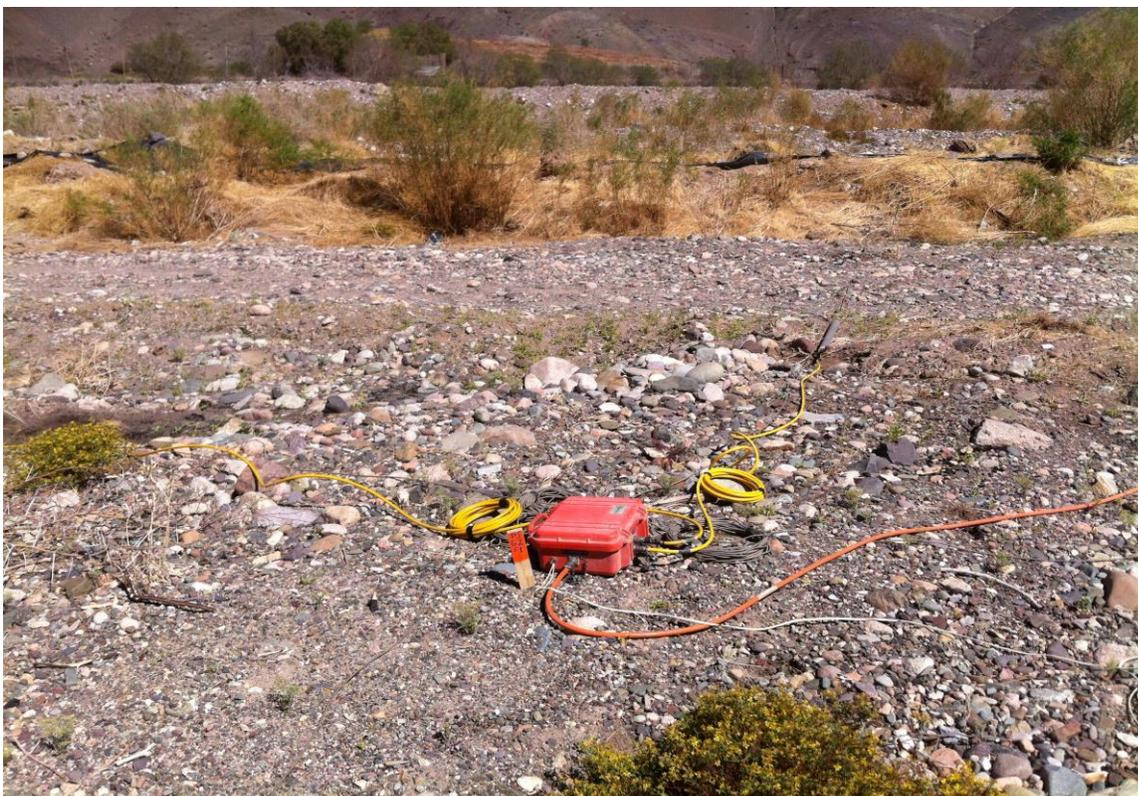
Foto 4. Muestra equipo receptor Electromagnético operando en terreno.
